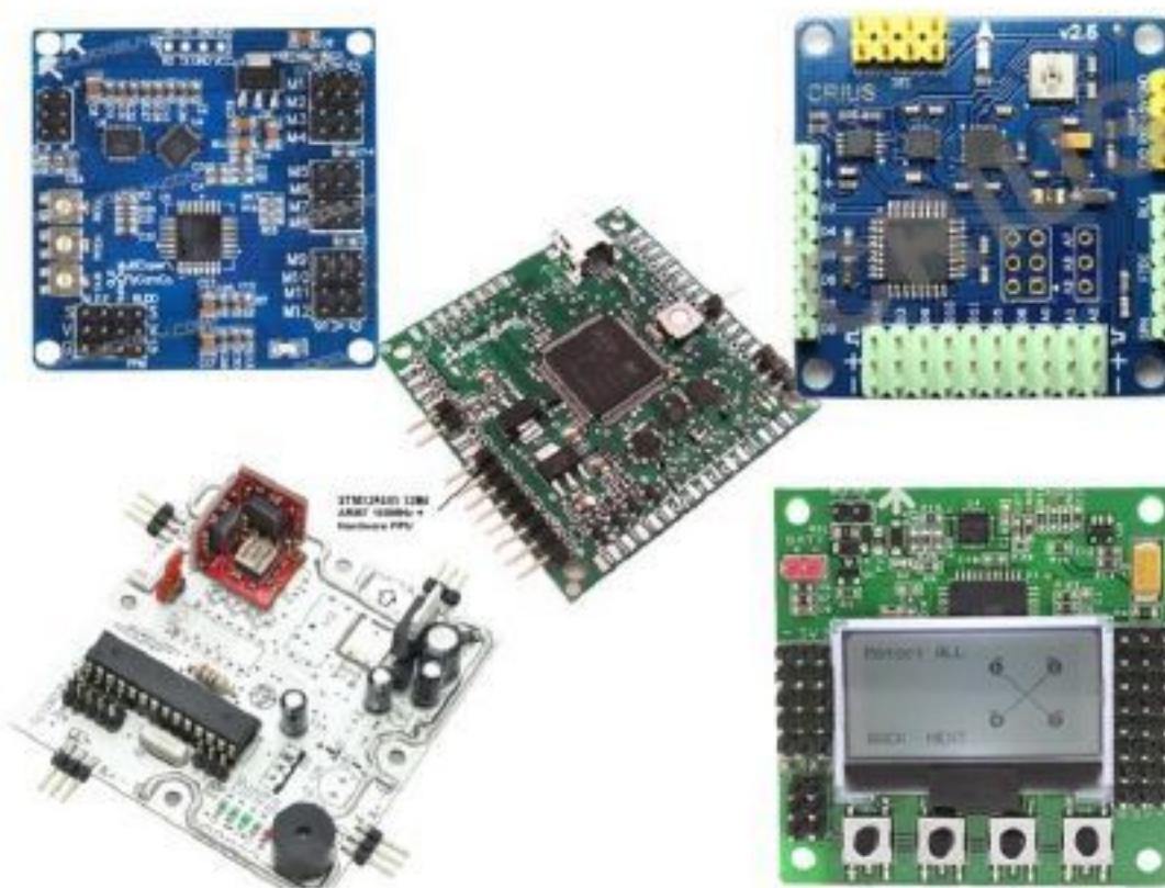
این فلایت کنترل ها که اغلب برای مصارف داخلی به کشور وارد می‌شوند، قیمتی در حدود ۳۵ الی ۲۰۰ دلار دارند. بخش اساسی و غیر قابل انکار هر فلایت کنترلی، بخش جایرسکوپ ها و شتاب سنج های آنهاست که موجب می‌شود یک IMU حداقل ۶ محوره تشکیل شود.
