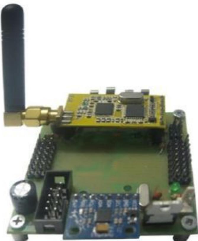
سوکت اتصال مازول GY521 ، سوکت اتصال LCD ، سوکتهاي اتصال راديو كنترل ، سوکت اتصال مانيتورينگ بي سيم ، سوکت هاي اتصال به موتور براشلس و .... امکاناتي است که همه توسط يك ميكروكنترلر AVR به نام ATmega128 مديريت مي شود.
